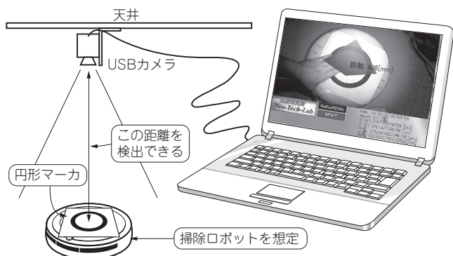
図1 試作したパターン・マッチング位置検出装置 オリジナル・アルゴリズムを使っており、マーカ図形が多少隠れても検出できる
