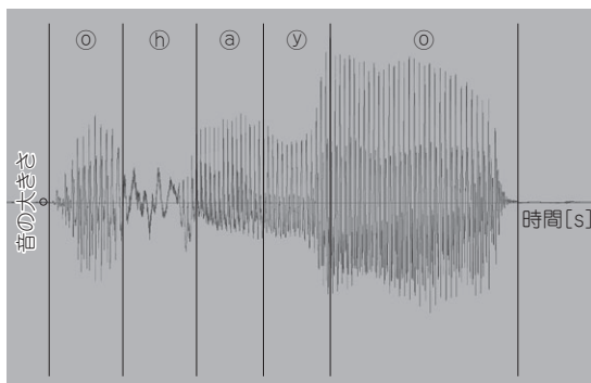
図2 音声波形は音素で構成されている 「おはよー」としゃべった場合は五つの音素になる
