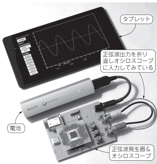
写真1 今回製作した4M サンプル/秒のBluetooth オシロスコープ & 正弦波発振器 発振器 & オシロスコープ本体の基板と電池、表示用タブレットという簡単な構成
