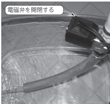
(b) 照明の代わりに電磁弁という部品をON/OFFすれば蛇口の開閉も可能
