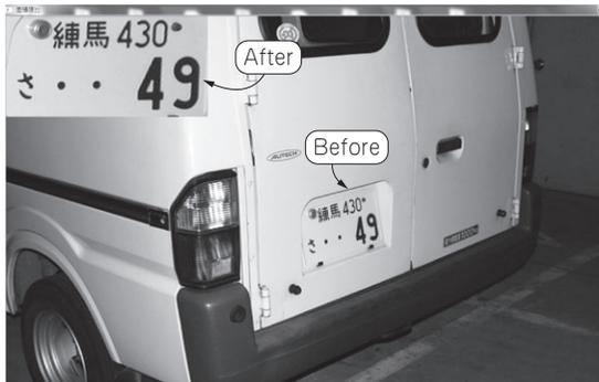
写真1 面積複比アルゴリズムによる斜め撮影ナンバープレートの正面画への復元
