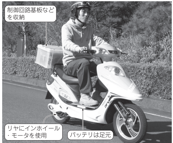
写真1 筆者らが解析・設計・製作を行った電動バイク
