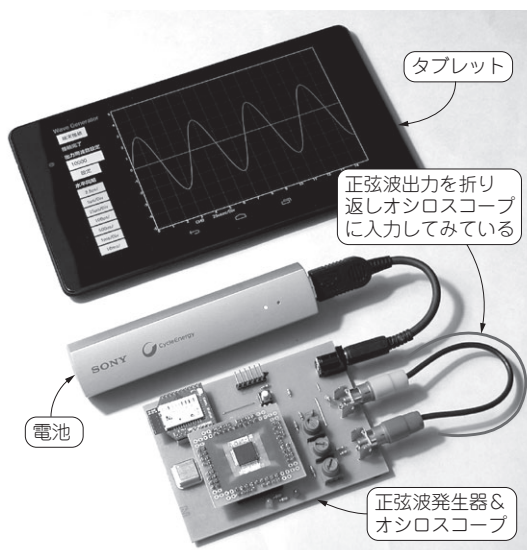
写真1 今回製作した4M サンプル/秒の Bluetooth オシロスコープ & 正弦波発生器
