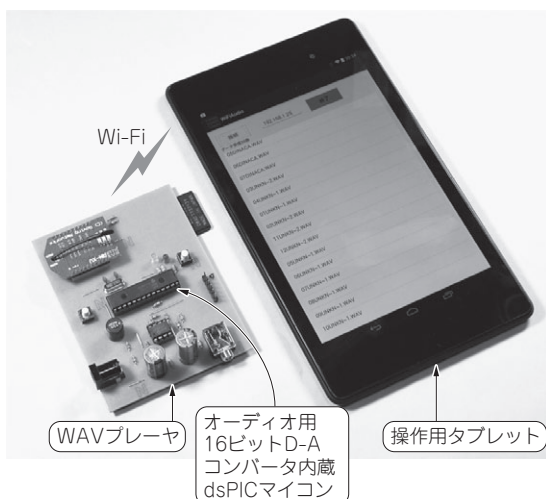
写真1 超シンプル! 製作した非圧縮WAVプレーヤ・システム
