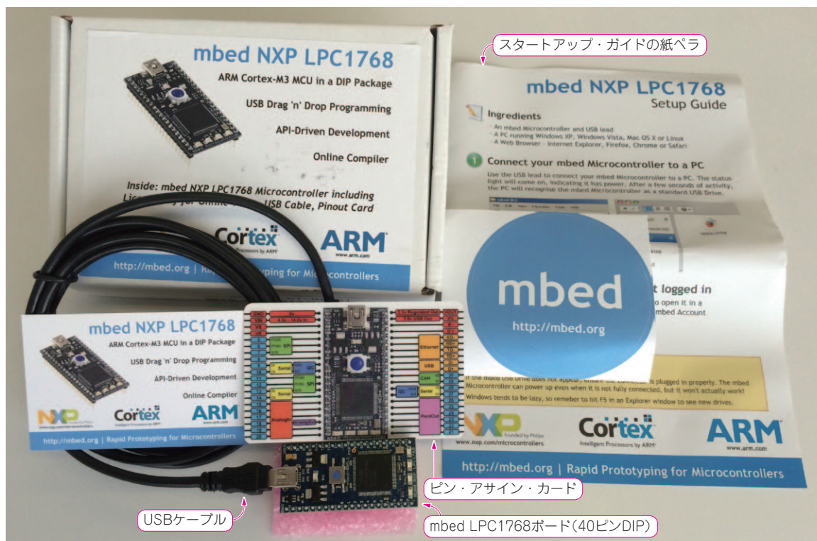
写真1 脱インストール&マニュアル! mbedはボードとUSBケーブルさえあればマイコン・プログラミングを本格的に試せるようになっている。純正mbed LPC1768の場合、同梱物は、ボード本体、USBケーブル(mini-B)、ピン・アサイン・カード、スタートアップ・ガイド(1枚の紙ペラ)、mbedシールだけ。
