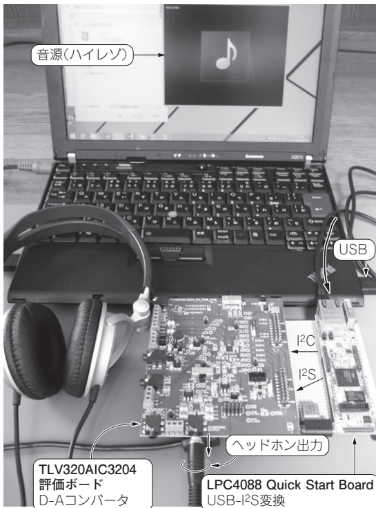
写真1 製作したUSBオーディオDACを使ってみた
