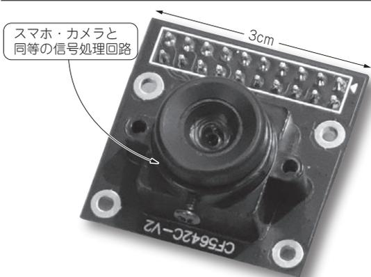
写真1 誰でも買える500万画素「OV5642カメラモジュール」
