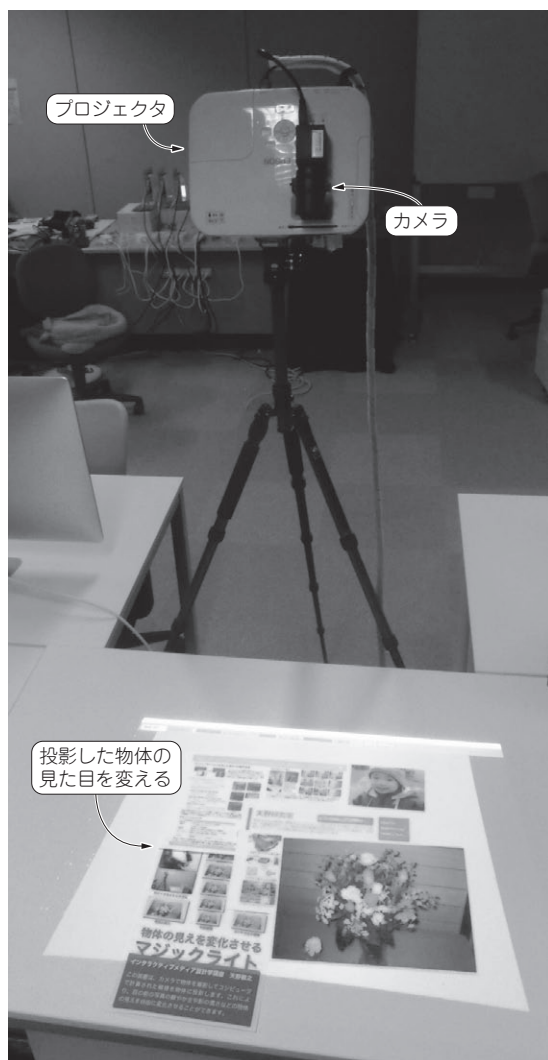
写真1 プロジェクタとカメラを組み合わせた見た目変換照明…マジックライト
