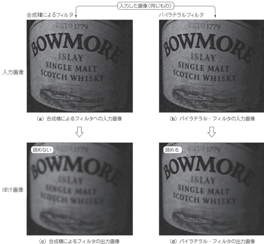
図1 輝度差が大きい画像のノイズを減らしてエッジを浮かび上がらせるバイラテラル・フィルタ
