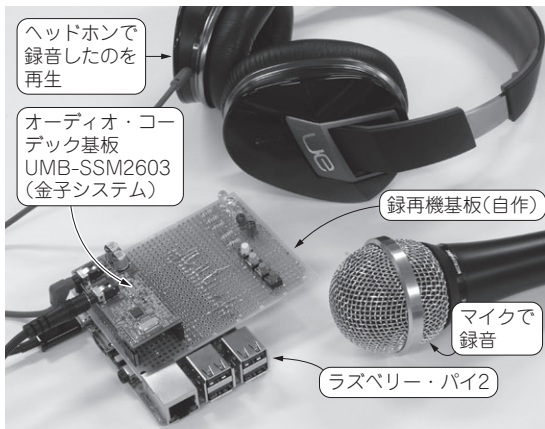
写真1 ハードもソフトもシンプルを追求! ラズベリー・パイ2を使ったハイレゾ・オーディオ録音&再生専用機
