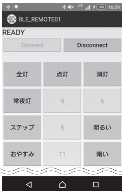
図2 Androidスマホ用家電コントロール・アプリの画面構成は複数の機器を操作することを想定したボタン配置とした
