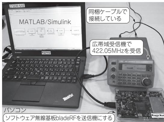
写真1 SDRで変調した422.050MHzの狭帯域FM波を聞く
