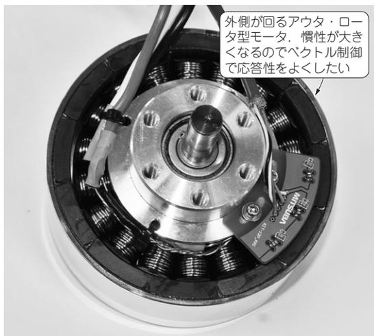
写真1 60W出力タイプのDCブラシレス・モータのお手軽センサレス制御に挑戦してみる
