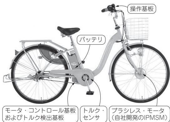
写真1 人間アシストの代表格! 電動アシスト自転車のしくみを大公開
