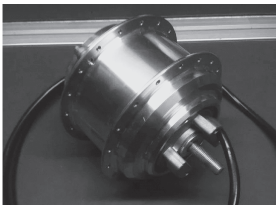
写真1 高効率なセンサレス・ベクトル制御が求められる最新DCブラシレス・モータ (230W出力IPMSMタイプ) 電動アシスト自転車用だがEVカートや介護カート、自走ロボなどにも向く
