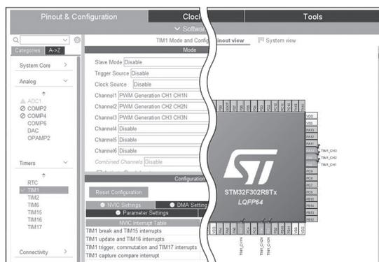
図1 STマイクロエレクトロニクスの開発環境はGUIでソースを吐き出しできる
