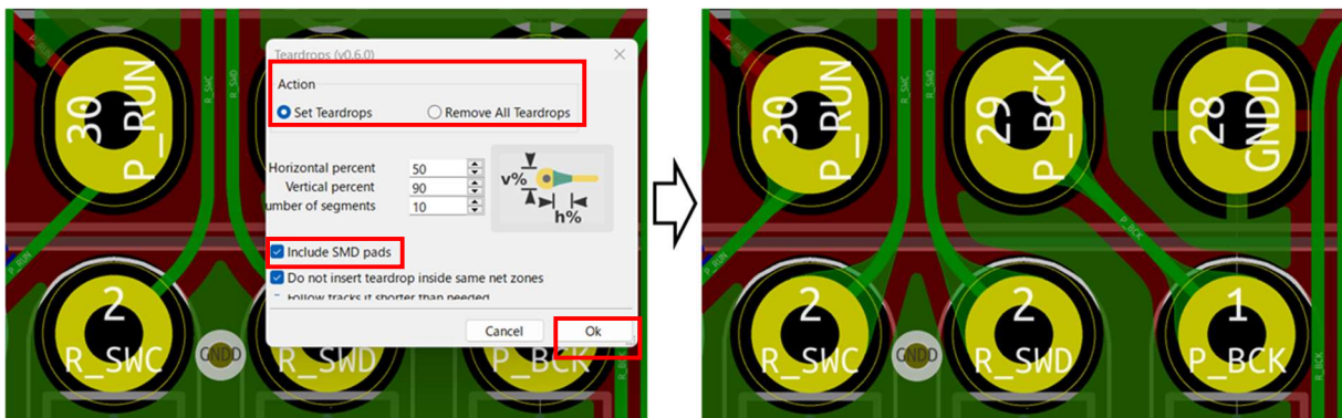
図 4 フィレット処理前(左)と処理後(右)の例
