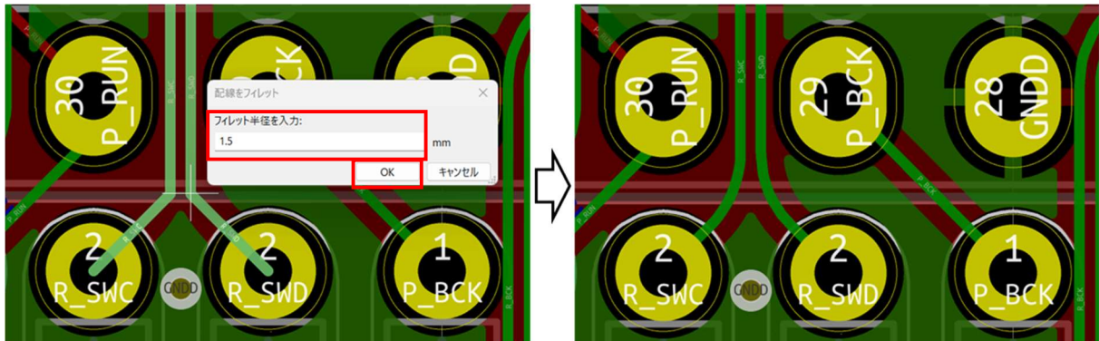
図 3 直線配線例(左)とフィレット処理例(右)
