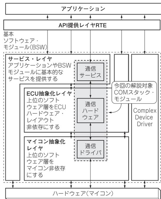
図1 AUTOSARソフトウェアの階層構造
